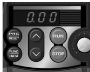
Рисунок 4.2 Изображение на индикаторе после включения электропитания
