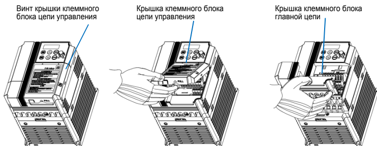
[Снятие крышек клеммных блоков]
